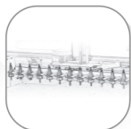
تعویض ابزار خطی Linear type tool magazine
