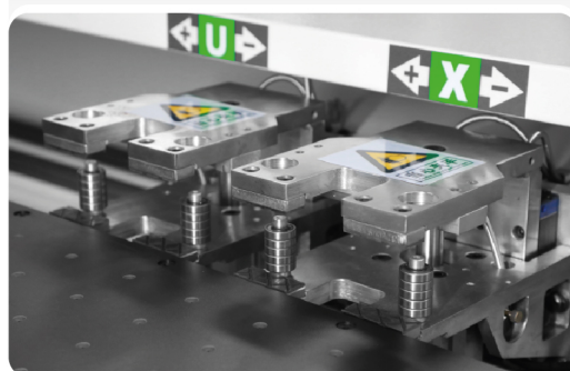
دو کلمپ کارگیر هوشمند Pneumatic clamping feeding device
